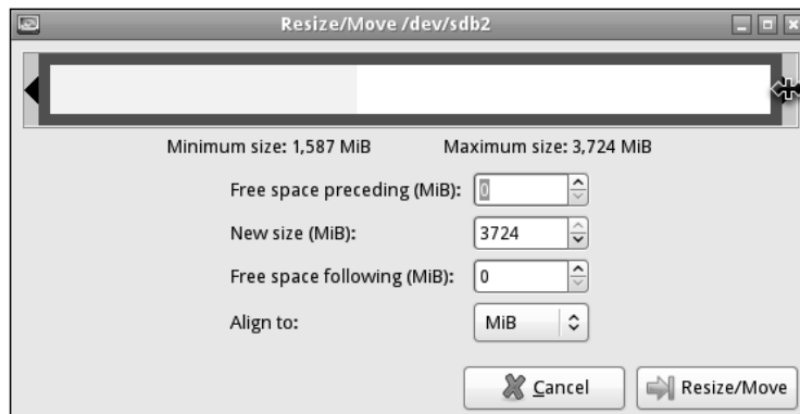
Obrázek 5.7: Změna velikosti kořenového systému souborů v editoru oddílů
