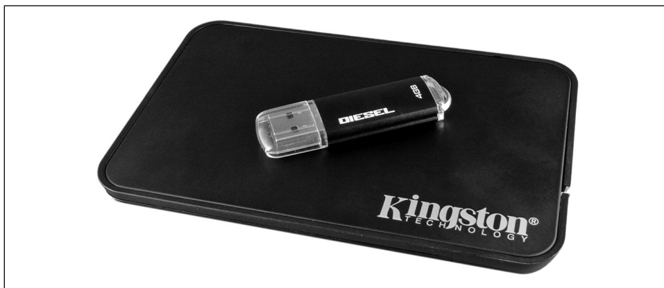
Obrázek 1.6: Dvě zařízení USB Mass Storage: flash disk a externí pevný disk
