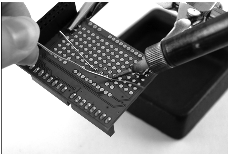
Obrázek 12.11: Pájení komponenty zasunované do otvoru na desku s tištěnými spoji
