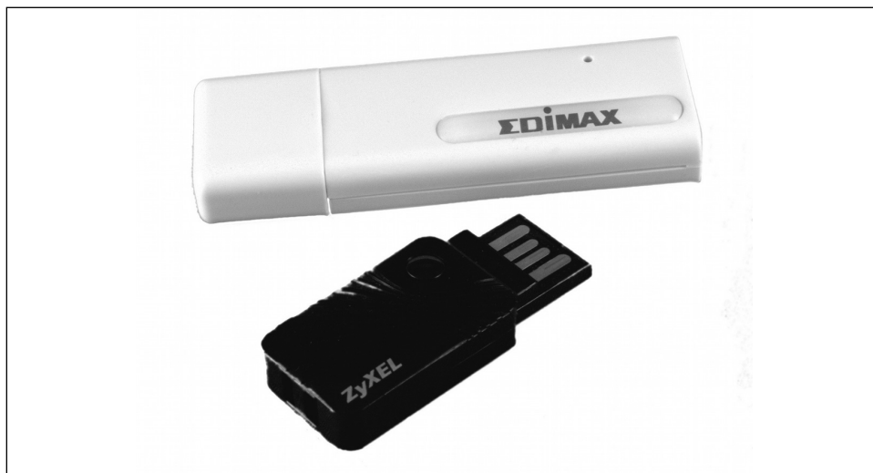
Obrázek 1.8: Dva bezdrátové adaptéry pro USB, které jsou kompatibilní s počítačem Raspberry Pi
