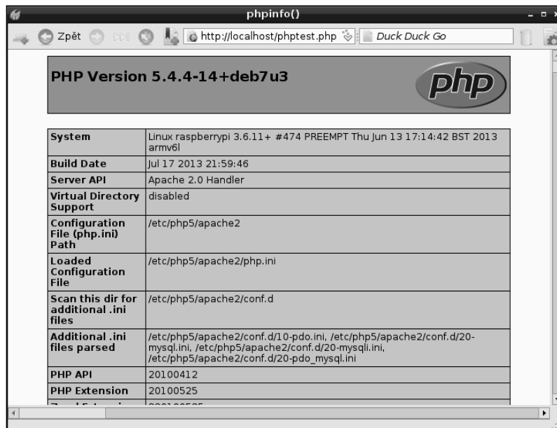
Obrázek 9.4: Testování modulu PHP serveru Apache v počítači Raspberry Pi
