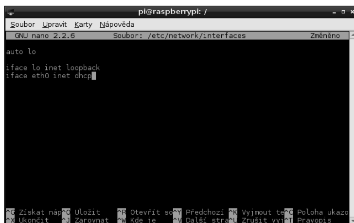
Obrázek 4.1: Úpravy souboru /etc/network/interfaces pomocí editoru nano
