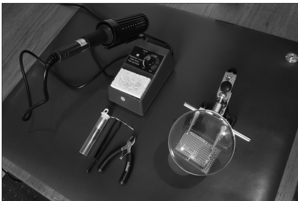
Obrázek 12.9: Ukázka pracovní plochy pro pájení s ochrannou antistatickou podložkou
