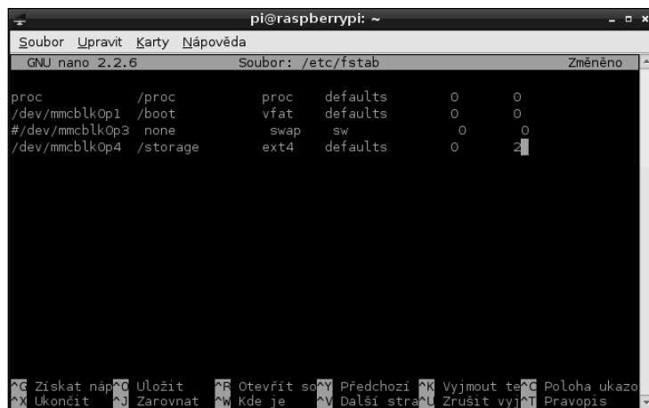
Obrázek 5.2: Úpravy souboru fstab , aby se nový oddíl připojoval automaticky
