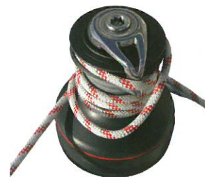
Přidejte na vinčnu po dotažení otěží otáčku navíc.
