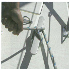
Správný (1) a špatný (2) způsob vedení zatíženého lana
