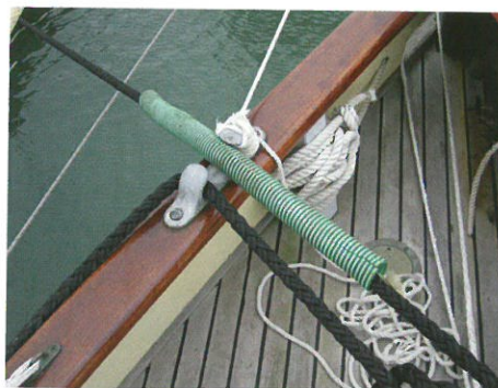
Kus hadice je levným řešením potíží s třením.
