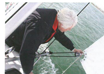
Při bočních kurzech použijte barberhauler.
