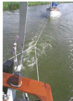
Tažná uzda rozloží zatížení na více vazáků.
