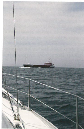
Pokud za lodí nejsou žádné orientační body, použijte pohled přes části lodě pro posouzení změn náměru.
