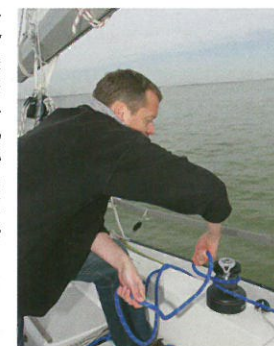
Když přitahujete lano otěží, mějte na vinčně vždy minimálně otáčku a půl.
