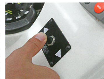
Použijte přídový propeler v pořádně dlouhých pulzech.
