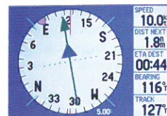
Tato GPS jednotka zobrazuje COG jako „TRACK“ a SOG jako „SPEED“.
