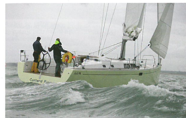
Při plavbě po větru zkuste refovat bez otáčení lodě.
