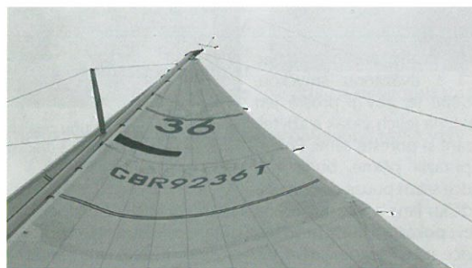
Břicho plachty můžete posunout dopředu či dozadu úpravou napětí horního výtahu.
