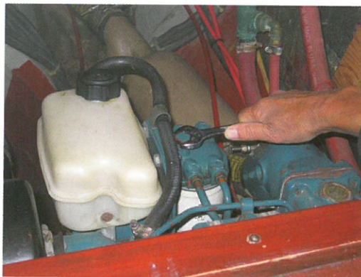
Odvzdušněte motor na palivovém filtru.
