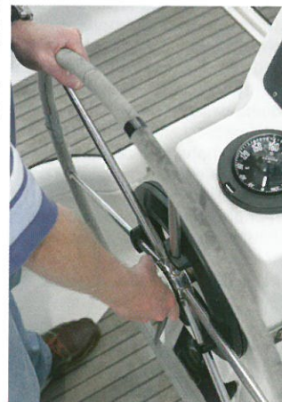
Při kotvení aretujte kolo ve středové pozici.
