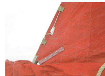
Pořádná hlavní plachta s trimovacím lankem přístupným u každého refu
