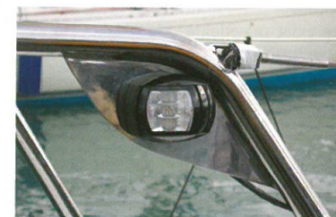
Světla využívající LED diody jsou sice dražší, ale úspornější.
