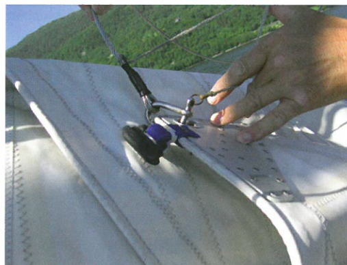
Kousek provázku zabrání ztrátě čepu.
