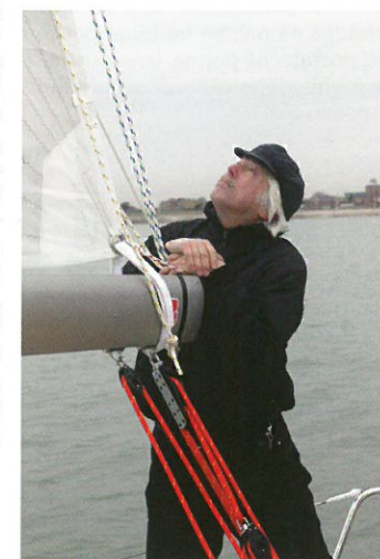
Lík bude optimálně vytrimovaný, pokud bude horní spira souběžná s osou ráhna.
