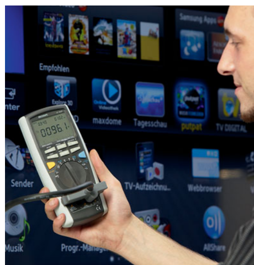
Pomocí fotometru měříme jas obrazu a barevnou odchylku.
