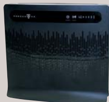
LTE Router Speedport od poskytovatele připojení Deutsche Telekom zvládá přenos pouze v pomalejším, 800MHz pásmu.
