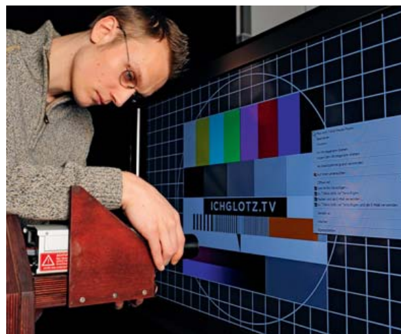
Hlavním nástrojem pro zjišťování opravdových parametrů televizních panelů je fotometr. Tato kamera měří úroveň jasu a barevnou koordinaci.
