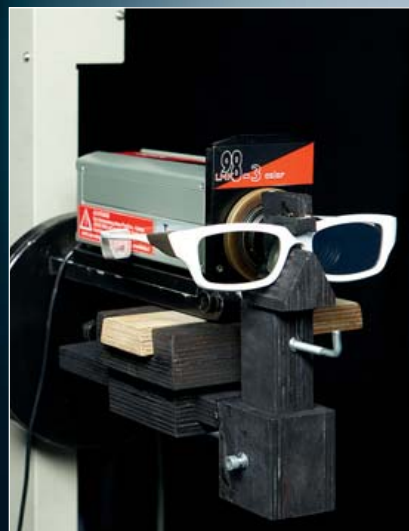
Kamera s brýlemi: Měření kvality 3D obrazu provádíme skrze závěrkové brýle umístěné na testovací stoličce.
