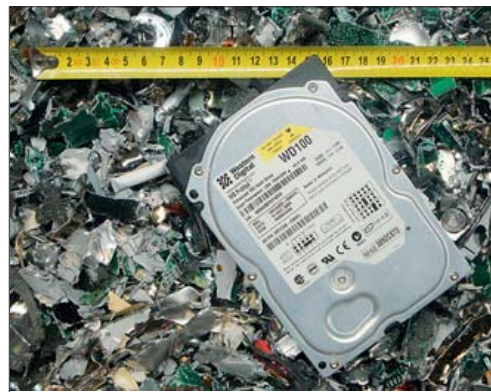
HDD skartovačka: Velká datová centra „rozstrouhávají“ staré pevné disky ve speciální skartovačce.
