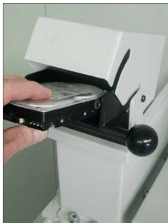
HDD skartovačka: Velká datová centra „rozstrouhávají“ staré pevné disky ve speciální skartovačce.
