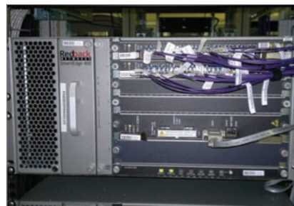
BRAS: Toto zařízení obsluhuje až 30 000 zákazníků.
