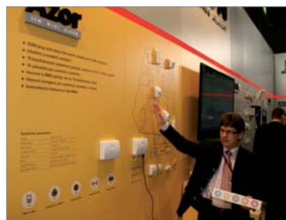
Azor: sestava bezpečnostního zařízení pro menší byt, která se skládá z detektoru pohybu, detektoru požáru, detektoru otevření dveří a komunikátoru.
