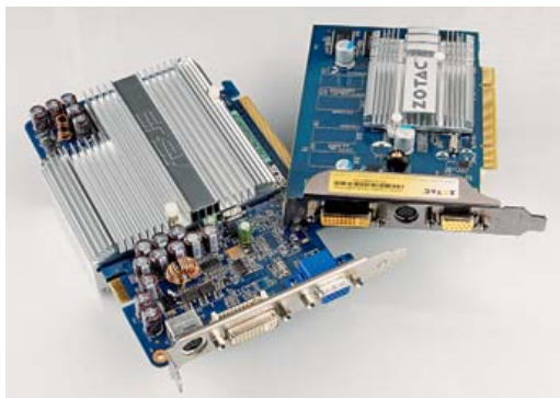
Pasivní grafika: Na trhu existují i pasivně chlazené, a tedy bezhlučné grafické karty, na kterých lze hrát středně náročné hry.
