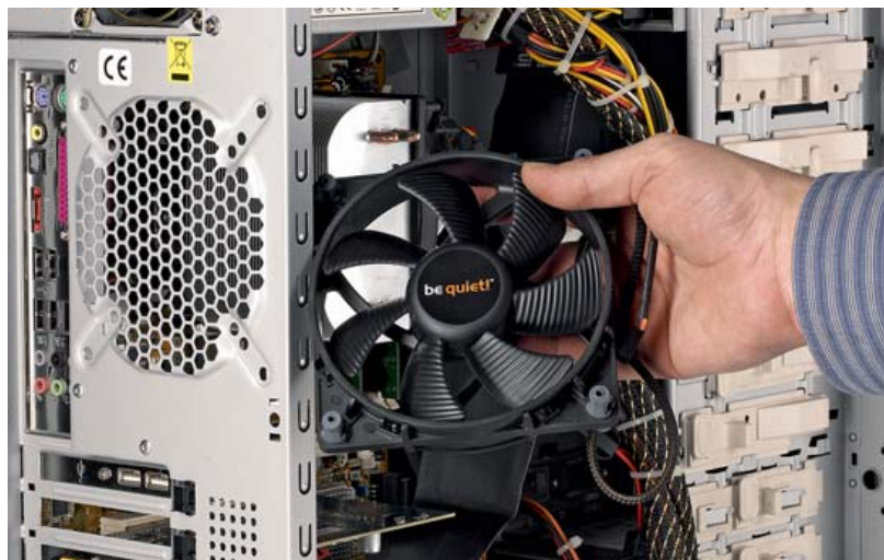
Velký je nejlepší: Do pozice výfukového ventilátoru skříně nainstalujte tak velký větrák, jak umožňují otvory ve skříně. Ideální je 120mm ventilátor s možností regulace otáček.
