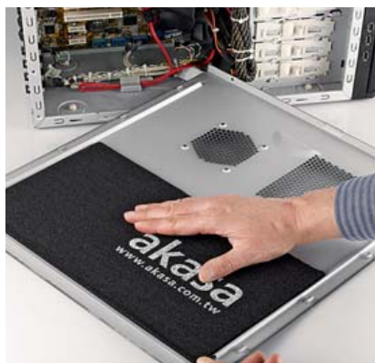
Izolace skříně: Izolační pěna sníží vibrace bočnic. Při montáži ji dobře vyhladte.
