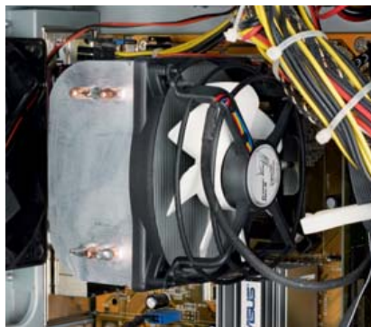
Po instalaci: Cenově dostupný chladič Arctic Freezer má hluchost jen 0,9 sonu. Má větší žebroví i ventilátor než klasický boxovaný chladič.
