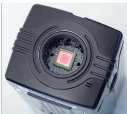
CMOS snímač: POE-100CAM v2 má výměnné objektivy.
