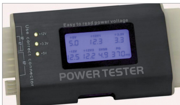
DeLock III: Zkoušečka zdroje může najít problém s napájením.
