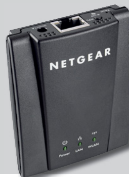
Z LAN do WLAN: Netgear WNCE2001 připojí každé zařízení z LAN konektorem k bezdrátové síti.
