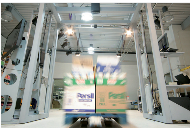
Zboží při průjezdu bránou: Na technologii RFID je postavený provoz obchodu budoucnosti v německém Rheinbergu.
