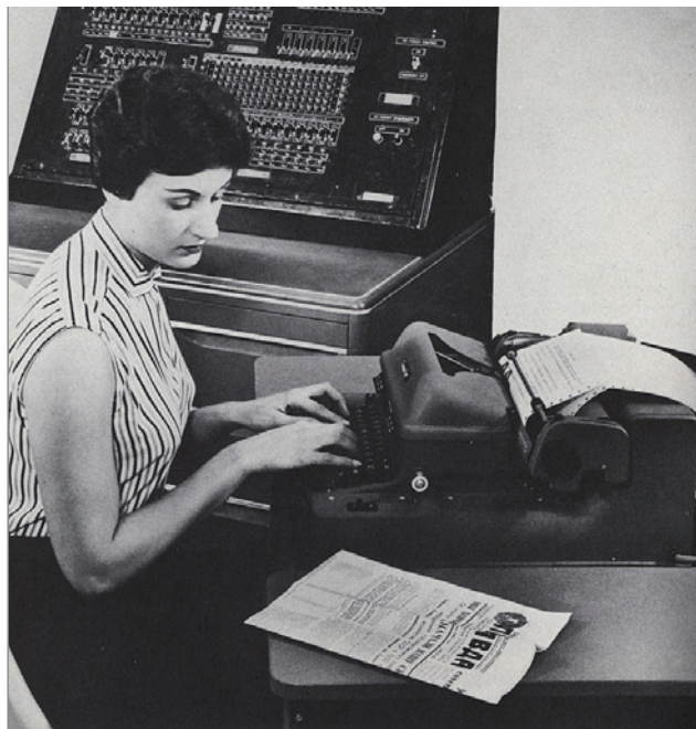
Překládání za studené války: Písařka kopíruje články z ruských novin Pravda na speciálním stroji, který písmena v azbuce převádí do vyražených děr v papírovém pásku. Převod je vytvořen po vložení pásku do stroje.
